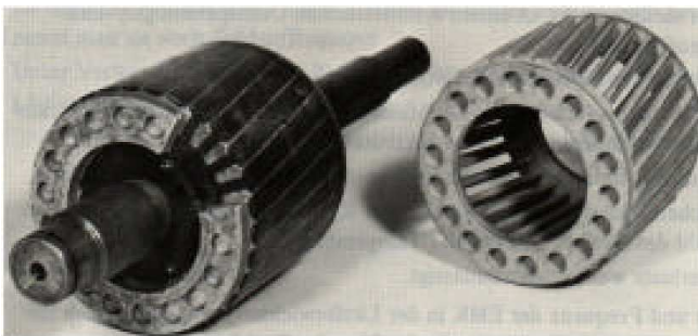
Fig.4.43.: Rotor jaula de ardilla.
