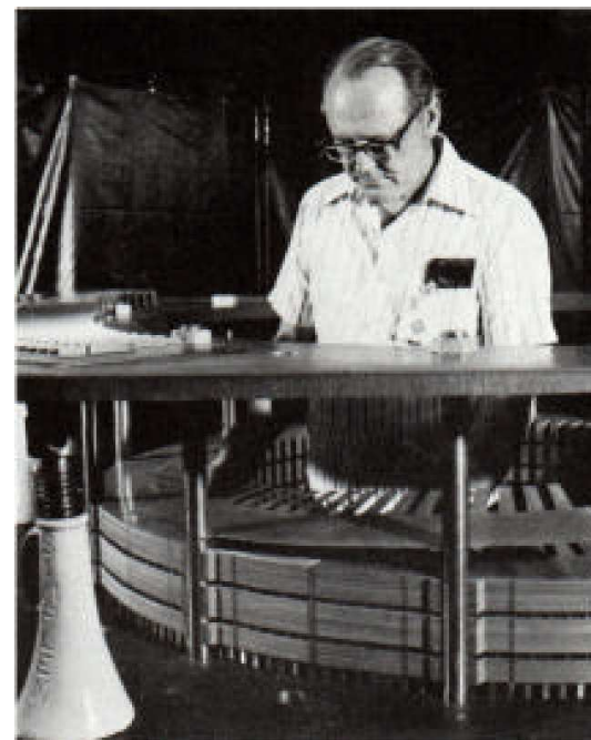
Fig.4.6.: Montaje de láminas del estator en un generador sincrónico.
