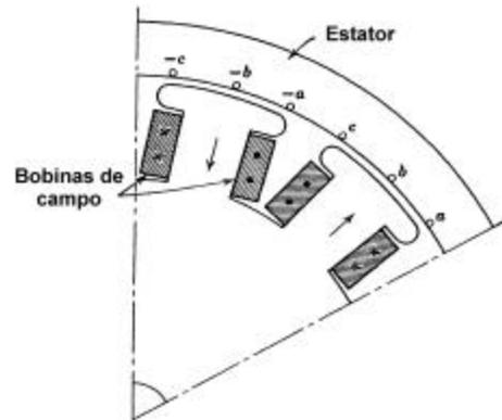
**Fig.4.43.:** Sector de una máquina de 12 polos.
