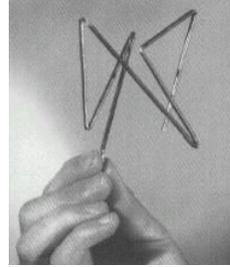
Los autores señalan que el diseño de tales antenas es un proceso impreciso, comenzando con las propiedades deseadas y luego determinando la forma de la antena mediante "conjeturas... intuición, experiencia, ecuaciones aproximadas o estudios empíricos" (p. 50). Esta técnica requiere mucho tiempo, a menudo no produce resultados óptimos y tiende a funcionar bien sólo con diseños simétricos y relativamente simples.
