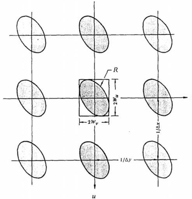
Fig 5.5: Representación en el dominio de frecuencia de una función bidimensional de banda limitada, muestreada.
