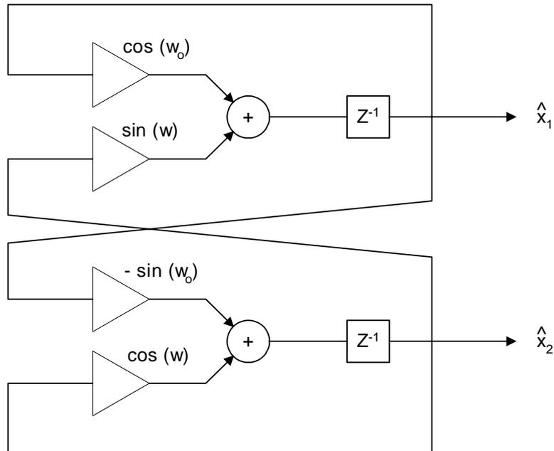
Figura 2: Oscilador acoplado en cuadratura. (Coupled-standard quadrature)
