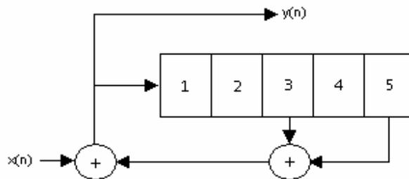
Figura 6: Esquema de un generador de números binarios aleatorios.
