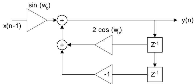
Figura 1: Oscilador digital sinusoidal. Conocido como oscilador Biquad
