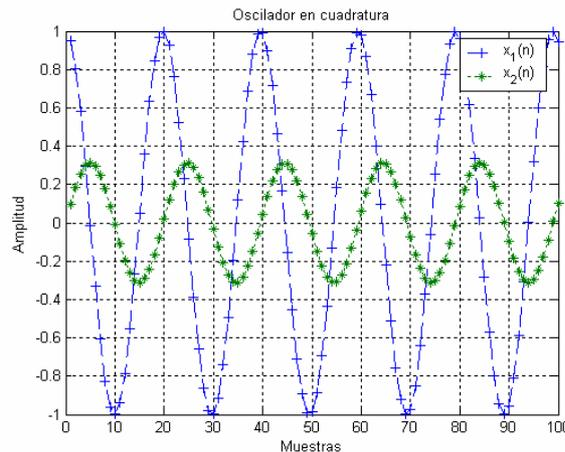
Figura 3: Oscilador digital en cuadratura. Diseño para distintas amplitudes.
